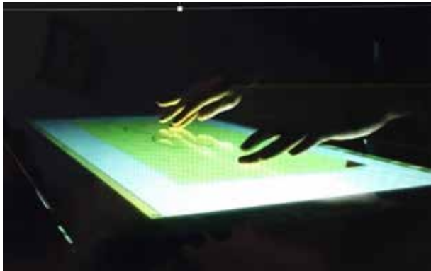
Figura 7: Uso de TraceSpace © en una superficie multitoque para replicar el uso de dibujo+papel del calco, de la manera usada en las críticas de mesa. Para un video mostrando la operación de la aplicación, acceda a https://bit.ly/2TtF1gx
